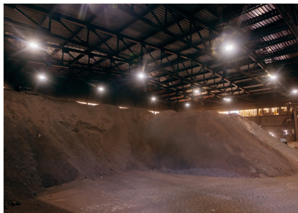
Afval uit de auto-industrie is het uitgangspunt voor de productie. Het wordt in een enorme hal opgeslagen, gemengd en vervolgens voorbereid voor reductie (afbeelding hieronder).
