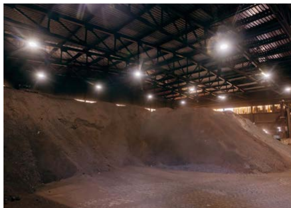
Abfälle aus der Automobilbranche sind der Ausgangspunkt für die Produktion. Sie werden in einer riesigen Halle gelagert, vermischt und dann für die Reduzierer vorbereitet (Bild unten).
