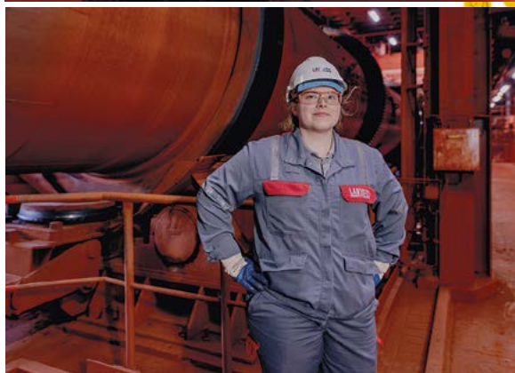
Regina Müller bei einem Kontrollgang in der Anlage. In den riesigen Drehöfen werden die schwarzen Pigmente zu roten kalziniert.
